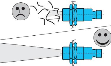
Die Wandleroberfläche sowie der Bereich der Detektionskeule ist zwingend frei zu halten. Es ist darauf zu achten, dass keinerlei störende Objekte zwischen dem Sensor und dem Zielobjekt innerhalb der Keule sind.
